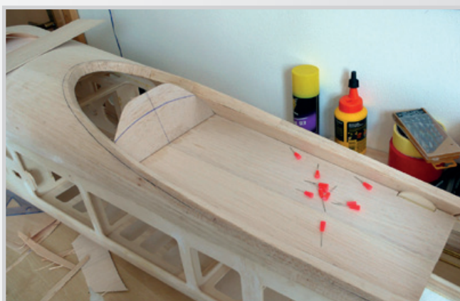
Čelo přístrojového panelu vyřízneme přesně podle tvaru dodané nálepky s přístroji a usadíme na správné místo
