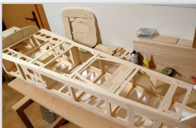
Příprava rámečku kabiny
