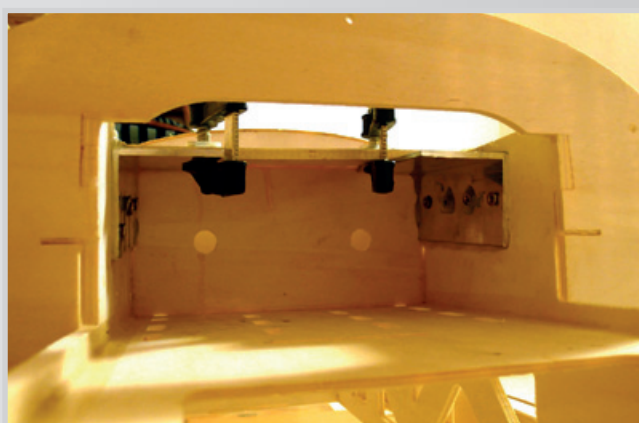
Zalepení a prošroubování vruty hliníkových L profilů pod podvozkovou desku pro větší jistotu spojení podvoku s trupem
