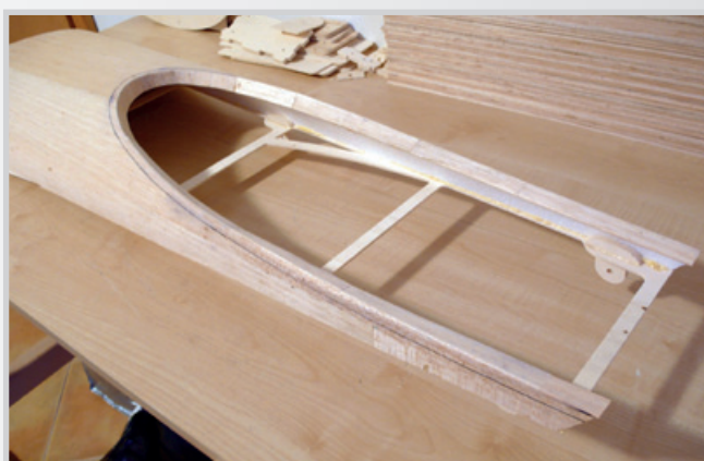
Polepení hran (i vnitřku který bude vidět) balzou 1,5 mm
