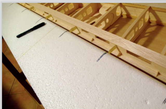
Příprava zářezu v křídélku pro položebra pantů
