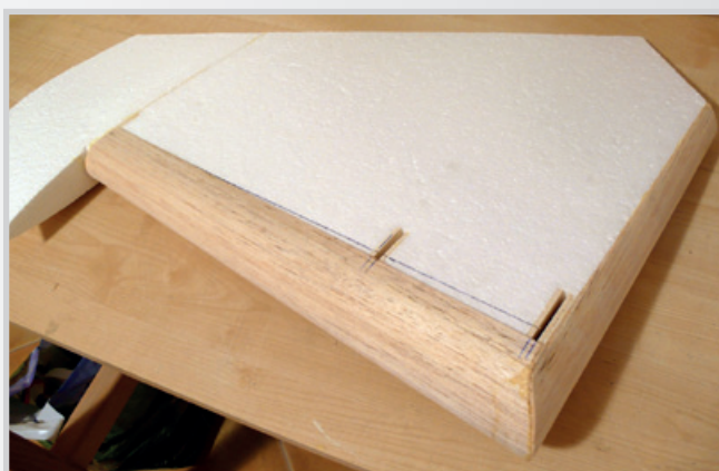
Polepení směrovky balzou 1,5 mm
