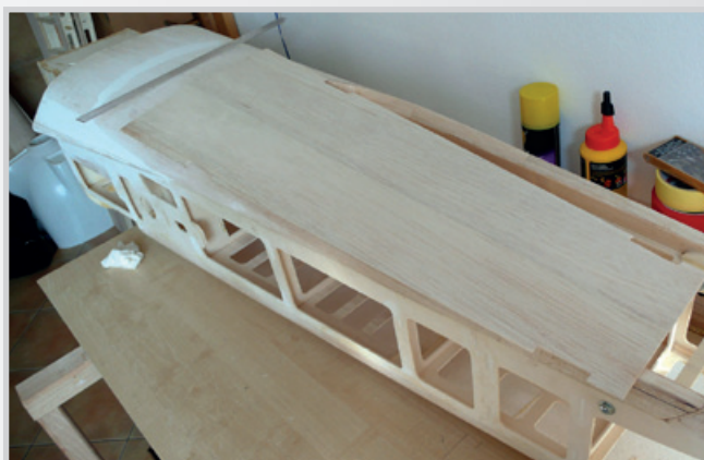
Vylepení spodku kokpitu - tvrdá balza 2 mm
