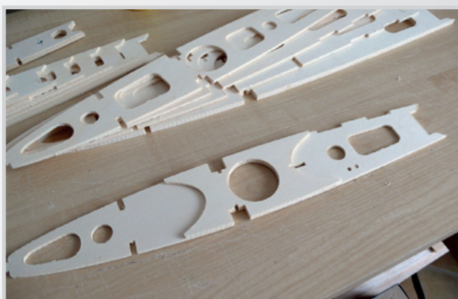
Vyztužení žebra kde končí trubka
