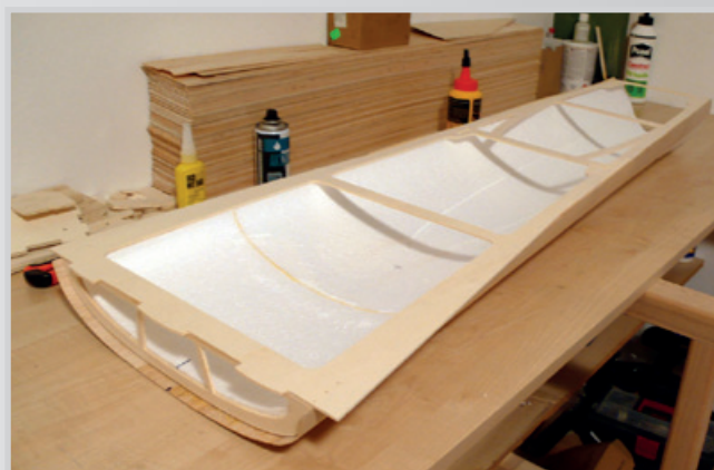
Slepení dílů překližky a polystyrenu - opět Purex
