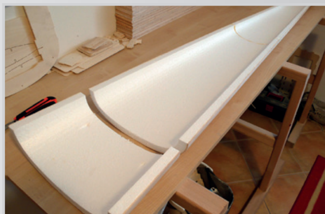
Příprava výřezu spodní části pro podvozek
