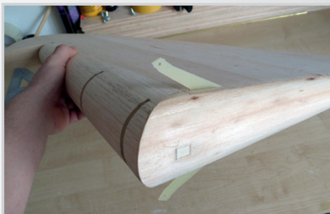
Výřez pro zasunutí páky směrovky
