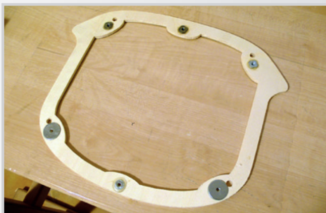
Vlepení velkých podložek do přepážky motorového krytu
