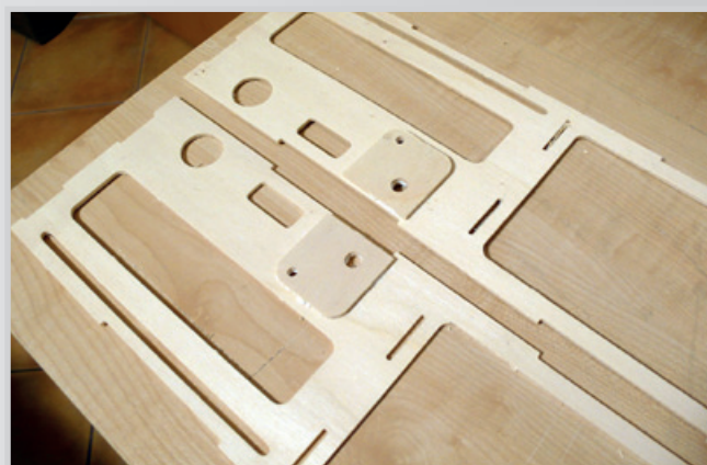
Zalepení výztuží pro kolíky z vnitřní strany bočnic
