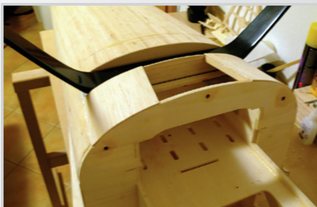
Zkušební vsazení podvozku
