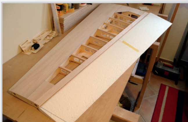
Příprava PS dílů pro křídélka
