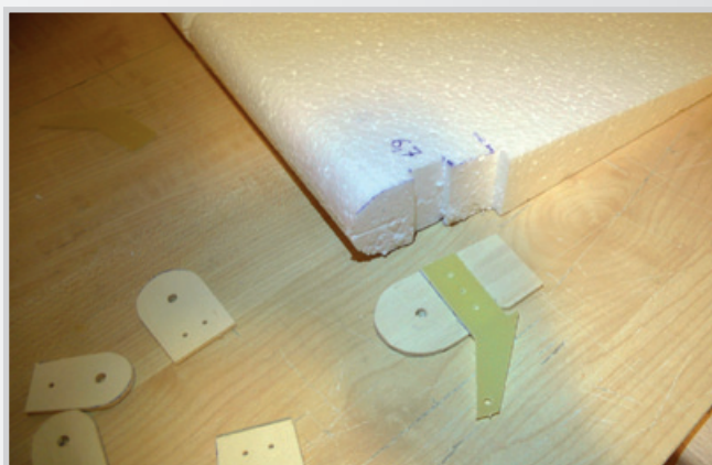
Příprava položebí a zářezů do výškovky
