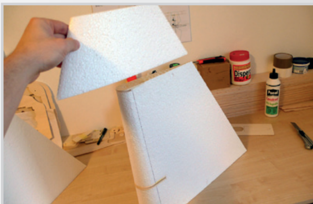
Slepení obou dílů směrovky
