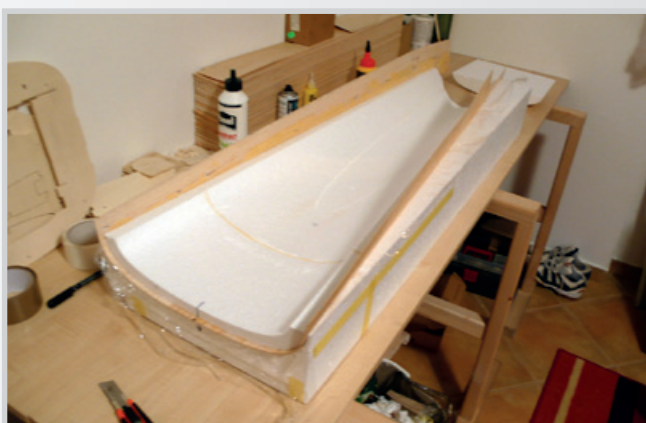
Příprava rámečku kabiny - sendvič opět s balzou 1,5 mm
