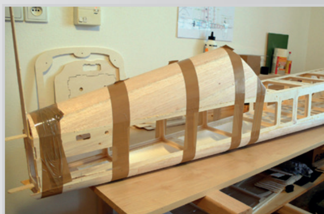
Zajistíme širokou páskou a necháme 2 hodiny schnout
