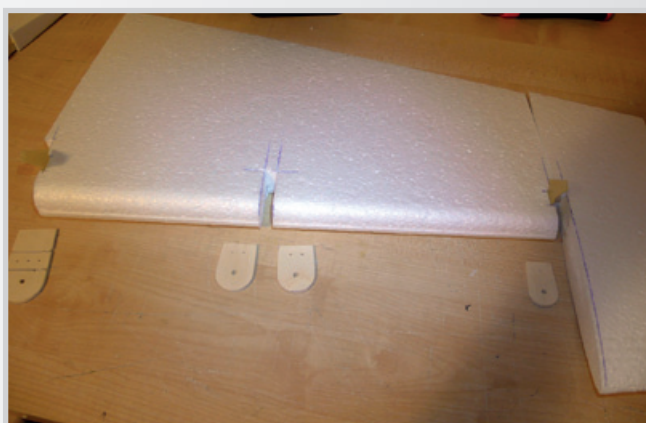
Vlepení všech položebí pro trubičku
