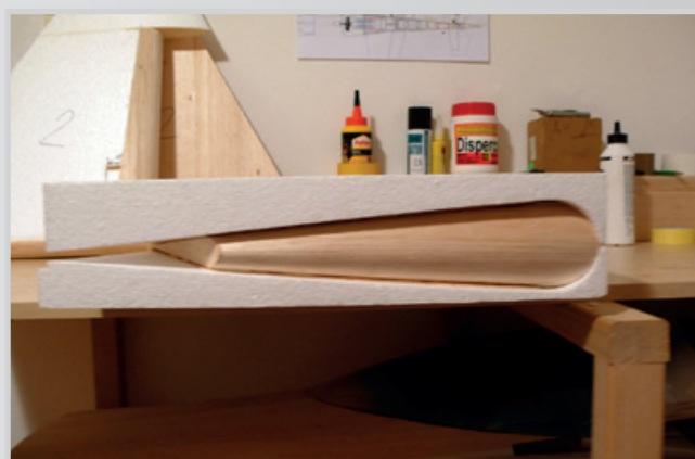
Polepení směrovky balzou 1,5 mm
