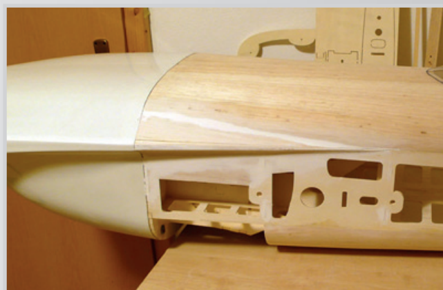
Vykitujeme a vybrousíme pro optimální navazování na motorový kryt
