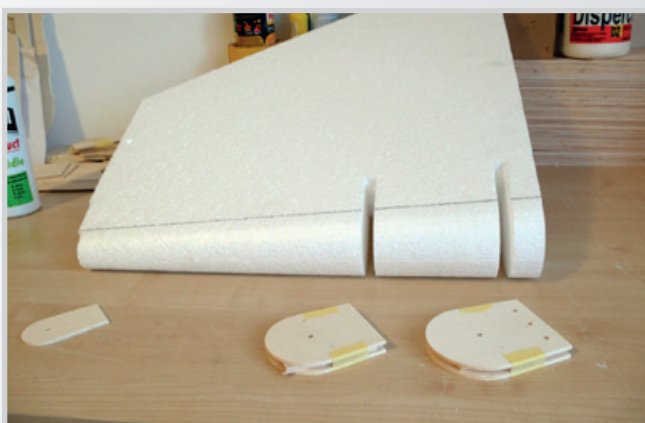
Výřezy pro položebra pantů (odměříme si podle trupu) - výřezy děláme 10 mm široké
