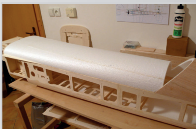
Příprava rámečku kabiny
