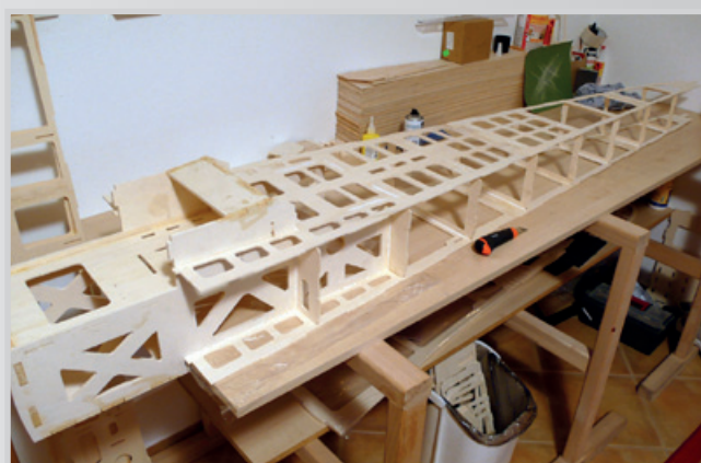
Vlepení přepážek a spodní základny trupu
