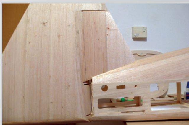
Sesazení se směrovkou a zalepení kýlovky do trupu
