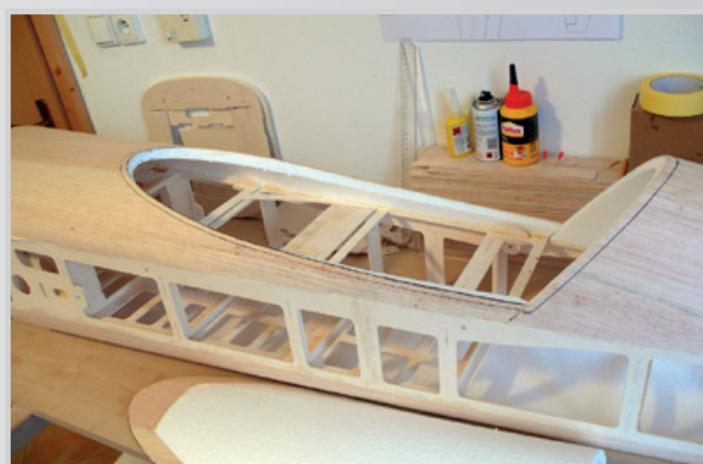
Odříznutí PS části pod kabinou
