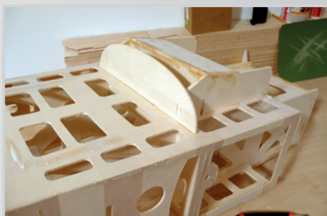
Polopřepážka bude přilepena k polystyrenovému spodku
