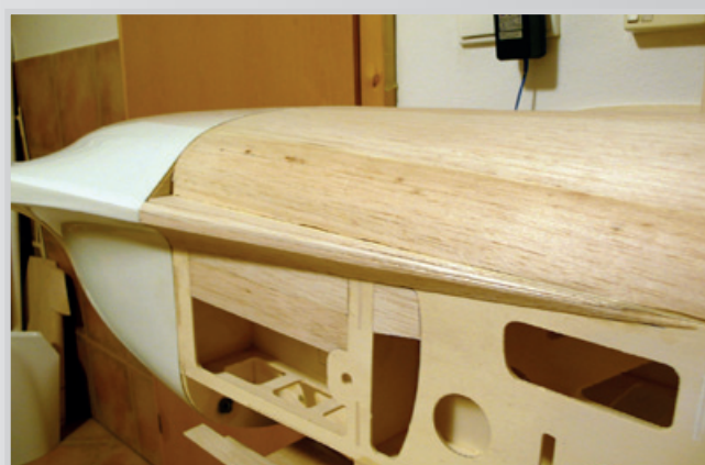
Protažení bočních trujúhelníku do bočnic trupu - slepíme z balzy 2 mm
