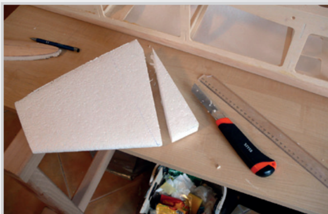
Odříznutí kýlovky podle úhlu turtledecku
