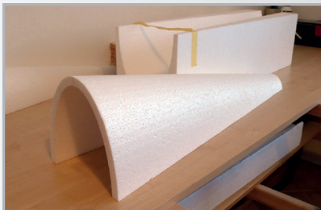
Příprava polystyrenových dílů - turtledeck
