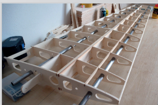
Vlepení lišt 5x10 mm
