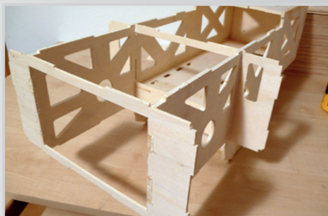
Vsazení přepážek k motorovému domku
