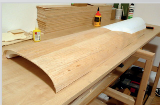
Nemusí být polepen celý - uřežeme část pod kabinou
