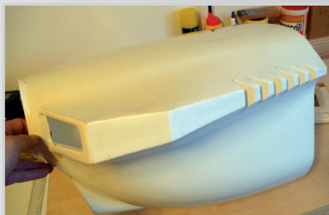
Výřezy funkčních výdechů vzduchu do motorového krytu
