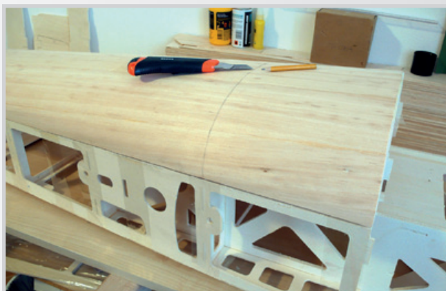
Příprava výřezu spodní části pro podvozek
