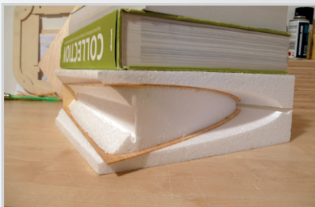
Polepení kýlovky balzou 1,5 mm
