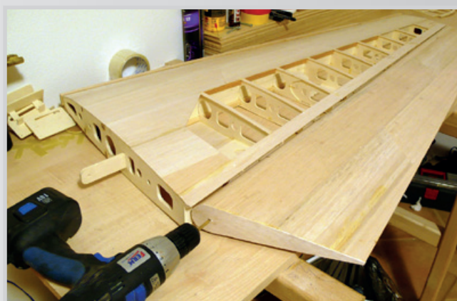
Polepené křídélko balzou 1,5 mm a jeho sesazení s křídlem - mosaznou trubičku uchytkáme do akuvrtačky - jde to lépe nasadit
