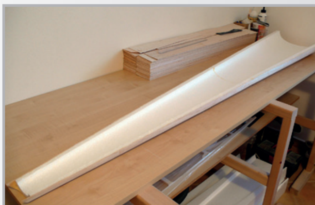
Příprava a polepení balzou 1,5 mm polystyrenových dílů - spodní část trupu
