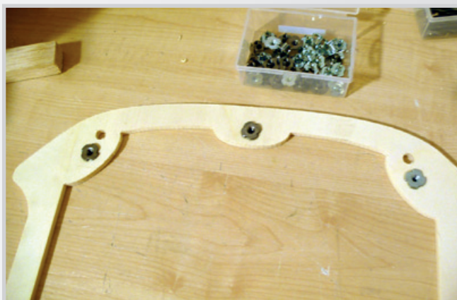
Vsazení zapichovacích matic M5 do přepážky motorového krytu
