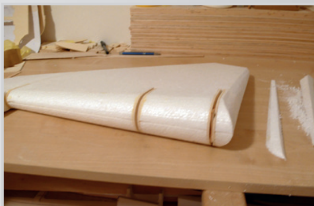
Směrovka připravena pro potah balzou
