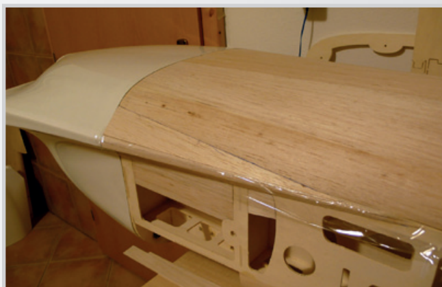
Protažení bočních trujúhelníku do bočnic trupu - slepíme z balzy 2 mm
