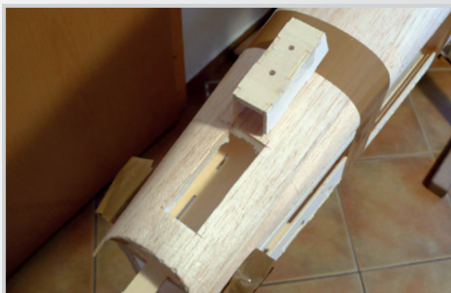
Vsazení držáčku ostruhy - uuitř dvě zapichovací matky M4
