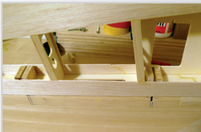
S nasazeným křídélkem zalepujeme panty uvití křídla - ke každému pantu vložíme z obou stran dřevěný špalík a zalepíme epoxidem
