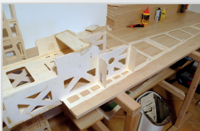
Sesazení motorového domku s vrchní základnou trupu
