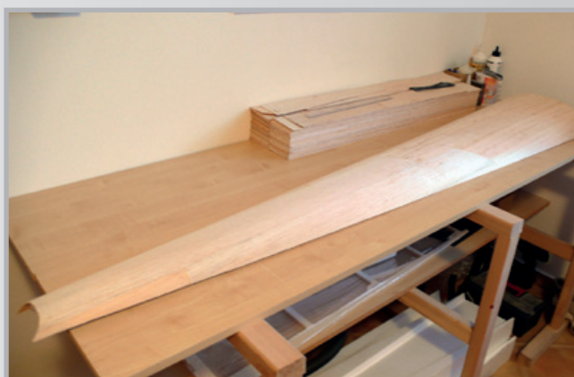
Příprava a polepení balzou 1,5 mm polystyrenových dílů - spodní část trupu
