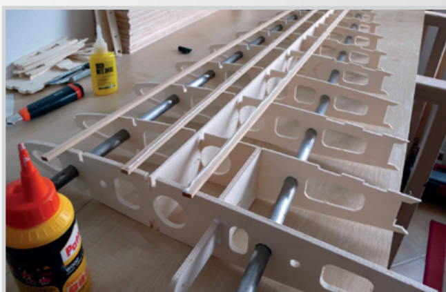
Vlepení lišt 5x10 mm
