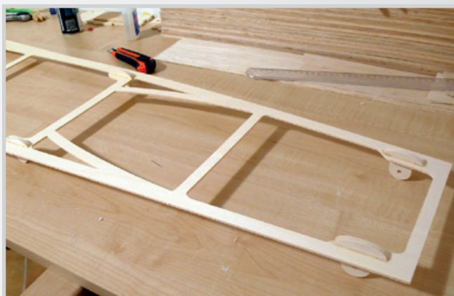
Vlepení úchytů z 6 mm - z vnitřní strany do nich zapícháme matky M5
