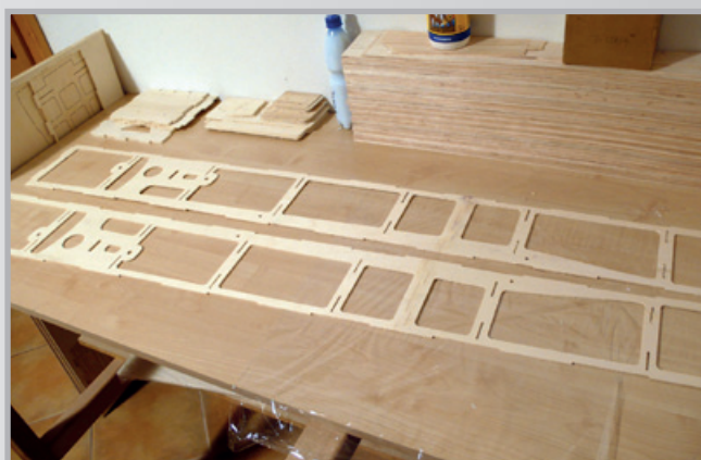
Slepení bočnic trupu ze dvou dílů
