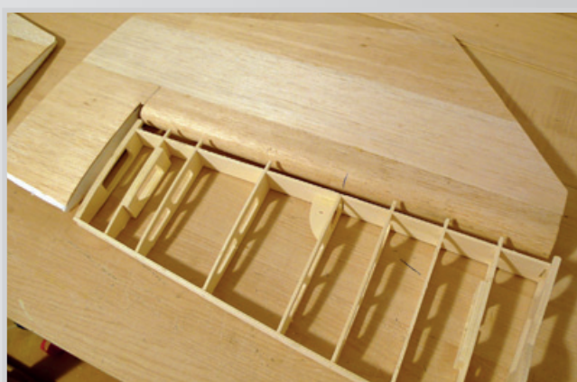
Sesazení stabilizátoru s výškovkou - poté nasuneme pouzdro trubky výškovky 20 mm a epoxidem zalepíme nasunutý panty výškovky
