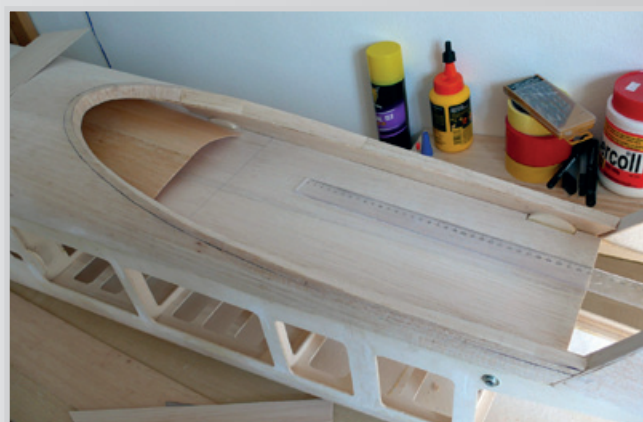
Příprava vršku přístrojového panelu
