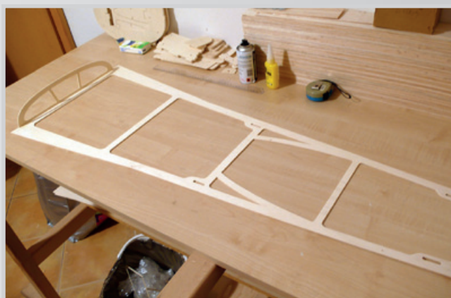
Příprava rámečku kabiny
