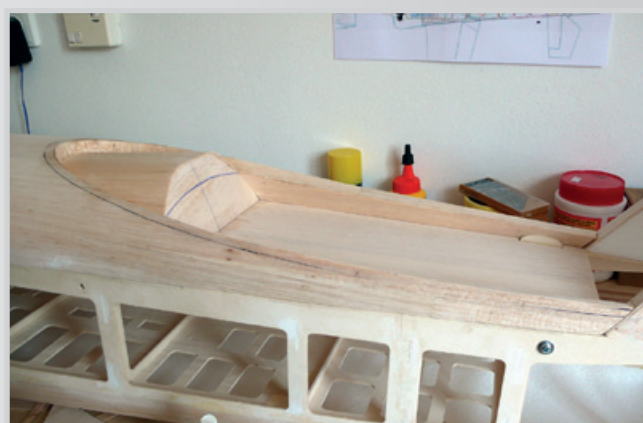
Slepíme čelo a vršek a zevnitř též slepíme Purexem se spodní částí rámečku kabiny
