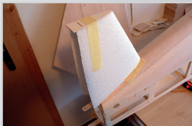
Přilepení horního žebra kýlovky - pod něj se zalepí horní pant směrovky ze slaminátu 3 mm
