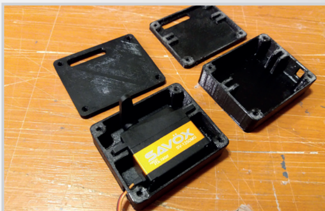
mini servo cases for elevator
