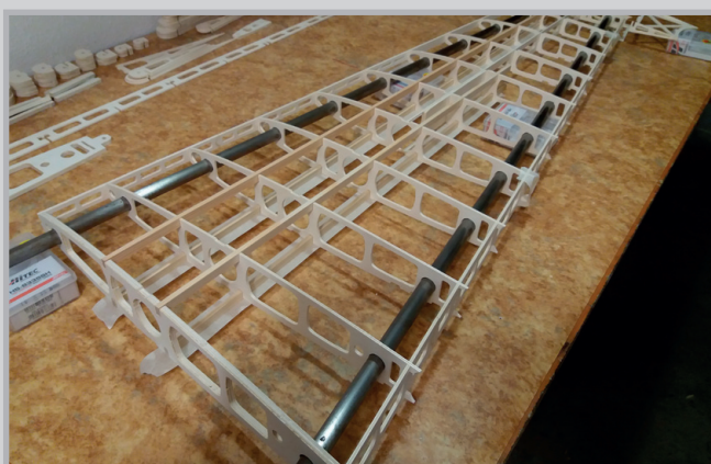
Navlečení trubek 16 mm
