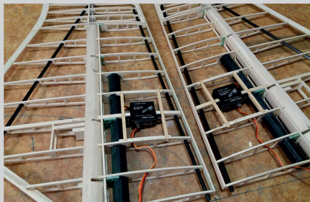
Výztuhy smrk 5x5 mm - zalepeny pro dekl serva, který se může (a nemusí) proříznout do balzového potahu zespoda výškovky
