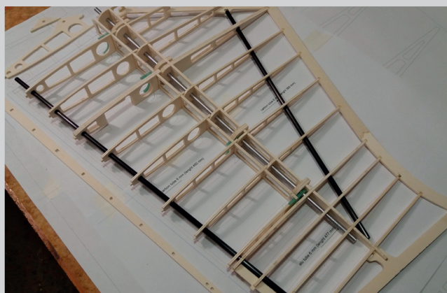
Pomocné uhlíkové trubičky 6 mm - přední se vyndá, zadní ve stabilizátoru zůstane zalepena
