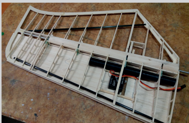
Tuhý potah náběžné části v jednom kuse - lepen CA na stojiny a na žebra disperzí
