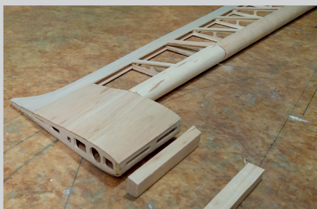
Křídélko potaženo balsou
