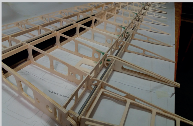
Sesazení s křídlem - z každé strany zastrčit cca polovinu metrové hliníkové trubičky 6 mm
