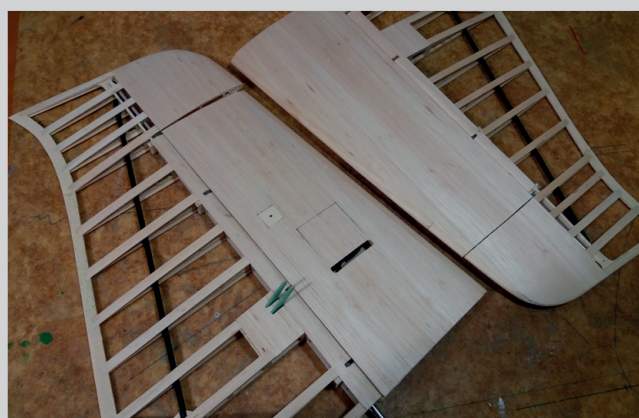
Výřez deklíku a díry pro servopáku
