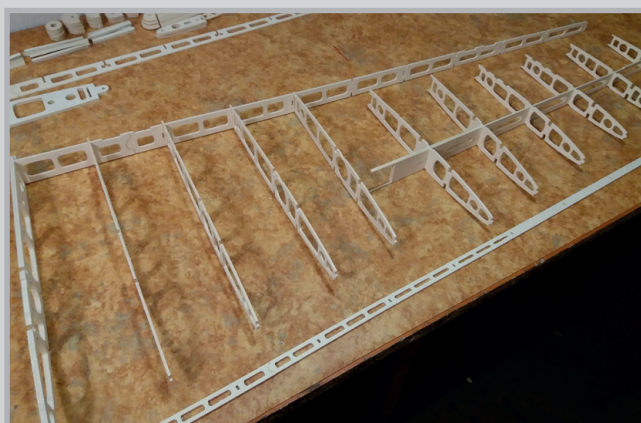
Sestavení žebíř a hlavní stojiny
