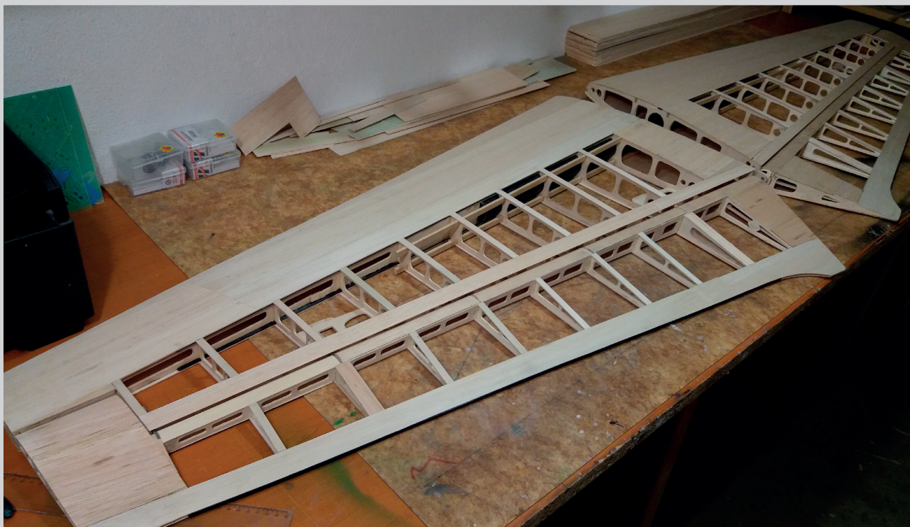
Křídla připravená pro potažení folií
