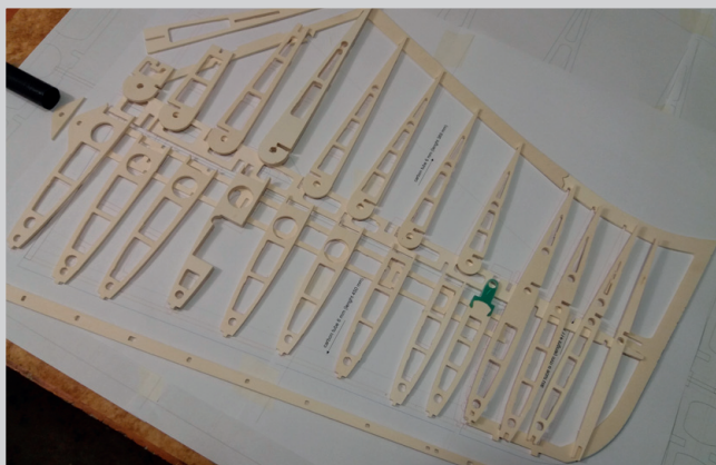
Příprava dílů výškovky
