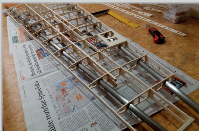
Sesazení žebér a nosníků smrk 5x10 mm
