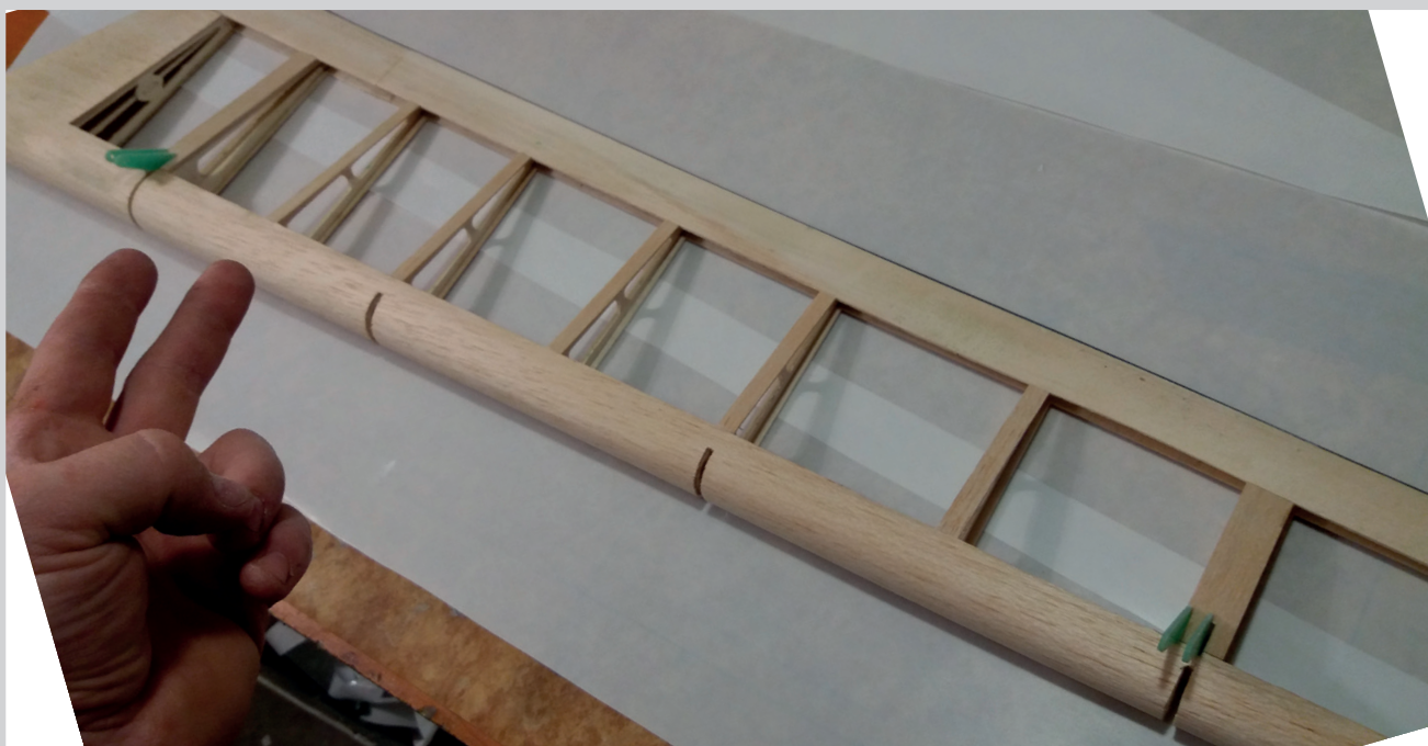
Výřezy děr pro usazení zdvojených pák křídélka
