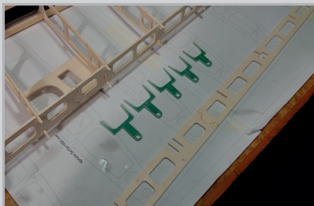
Příprava závěsů - díry projet výstružníkem 6 mm
