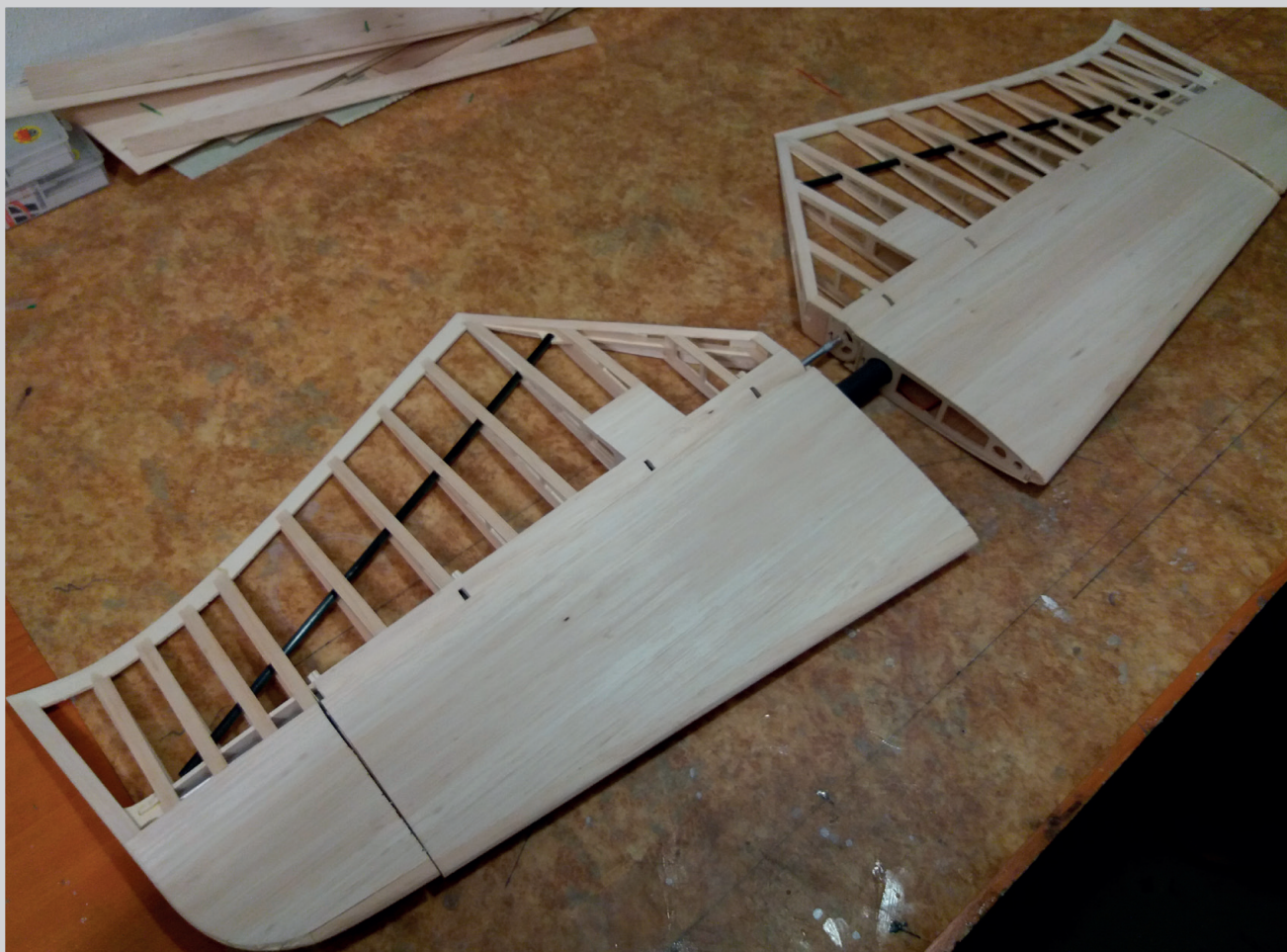
Páskování žebér výškovky - zbroušeno do ztracena
