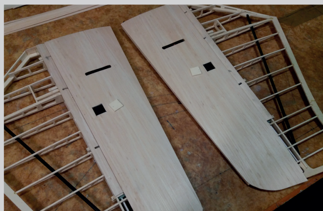
Nad trubkou vyříznout čtvereček balsy a nahrazen překližkou - pod ní dát trochu epoxidu s mikrobalony
