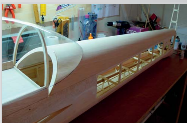
30. Turtledeck (sendvič polystyren a balza) k trupu přilepen purexem
