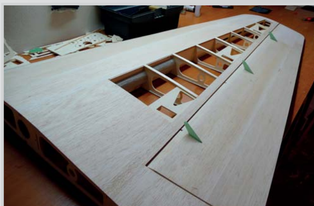
66. Vyřiznutí otvorů pro páky - možno použít 2 nebo 3 serva
