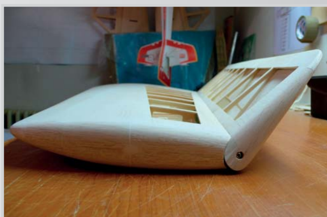
64. Zařízení přesahu balzového potahu odtoku křídla - nastavení výchylky křídélka
