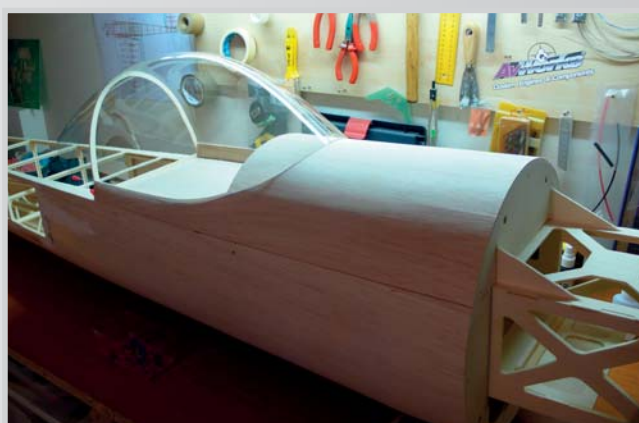
28. Potažení vrchní kryt s kabinou
