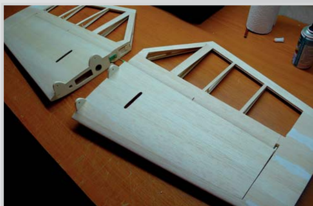
42. Kompletní výškovka - potažena lehkou balzou 2mm - jedna polovina váží 210 g
