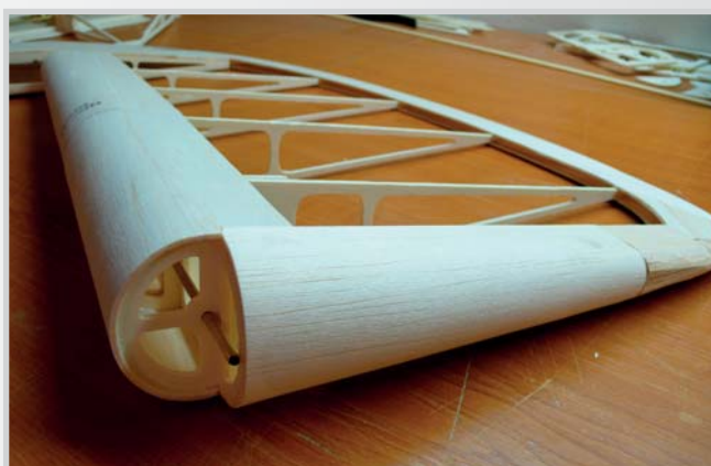
33. Spodek potažen stejně jako čelo, jen na tenký konec je vlepen špalek balzy
