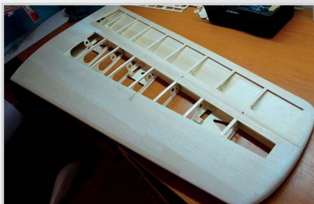
65. Kompletní obroušené křídlo s náběžkou a koncovým obloukem - váha 890 g
