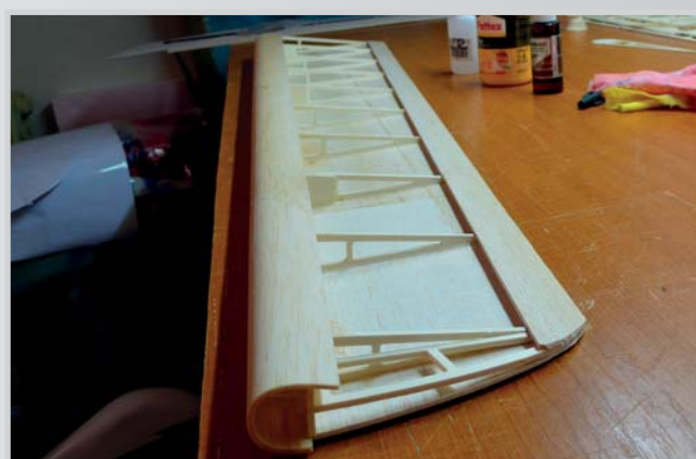
60. Zajištění CA lepidlem (nebo špendlíky) na hraně hlavního nosníku křídélka
