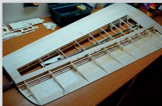
56. Přilepena odtoková lišta z vrchní strany
