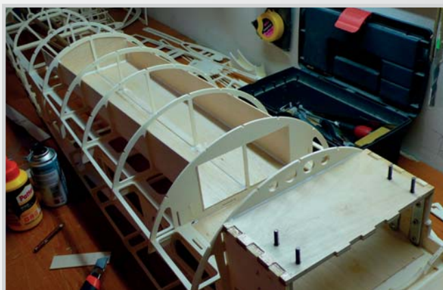
11. Uzavření prostoru pro laděné výfuky 3280 - MVVS
