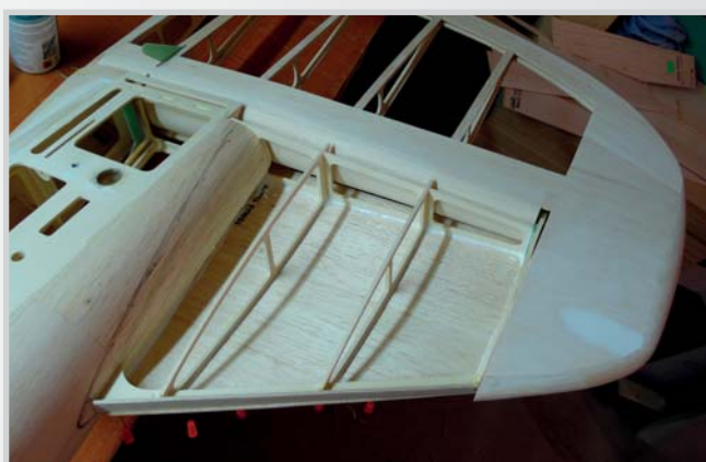
35. Vlepení žebér SOP a potažení
