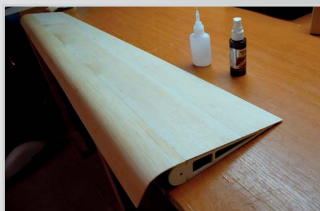
58. Přilepení CA lepidlem jedné hrany
