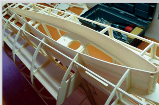
12. Vlepení vnitřního potahu b2
