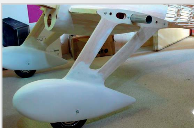
45. Obroušeno - dřevěné díly je potřeba olaminovat a připravit pro barvení
