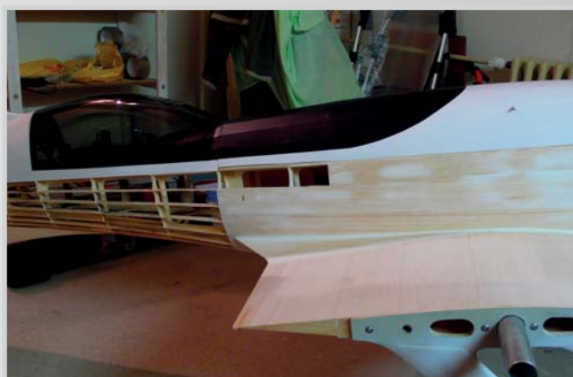
52. Nastříkaný vršek trupu se zatmavenou kabinou
