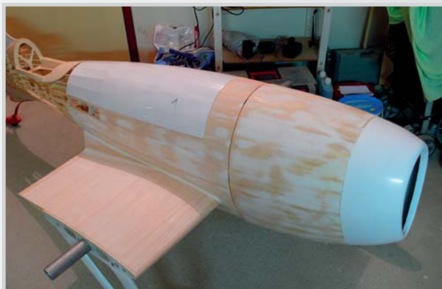
49. Začátek povrchové úpravy - celý kryt olaminován a stříkána autobarvami
