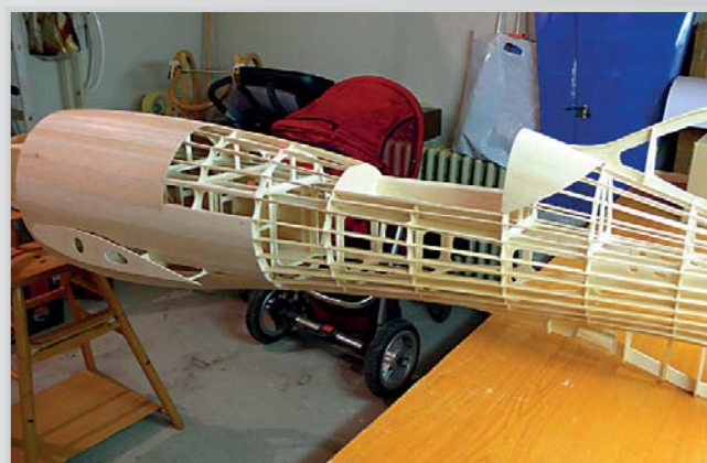
18. Kompletně potažená přední část trupu
