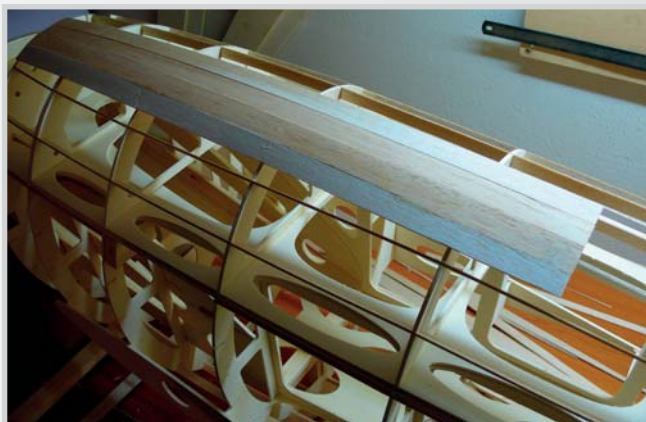
13. Páskování přední části trupu - balza 2 mm
