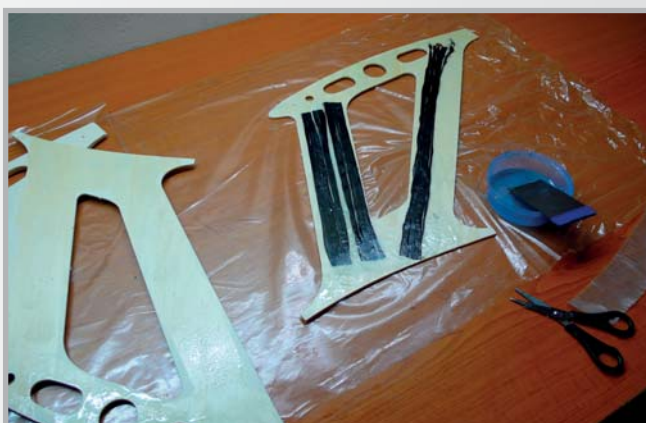
3. Podvozkové nohy lepeny epoxidem + tkanina + uhlíkový roving
