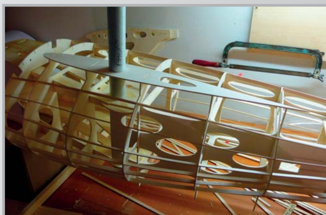
10. Pouzdro spojky křídel pro trubku 35 mm
