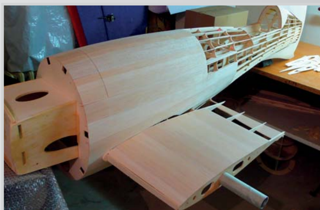
24. Kořen křídel potažen balzou 2 mm
