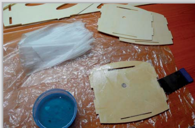
2. Motorové lože - lepeno epoxidem
