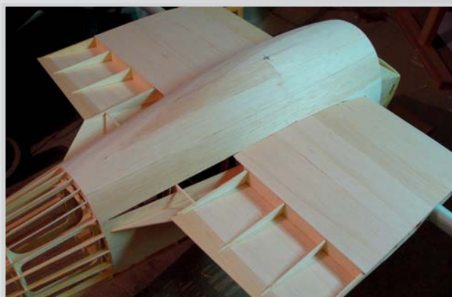
26. Nepotážená část pro odštěpné brzdicí klapky
