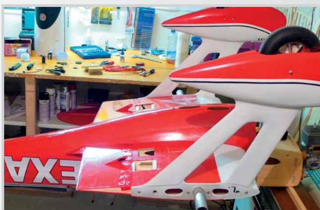
59. Vlepené panty a páky k brzdícím klapkám + připravený otvor pro servo
