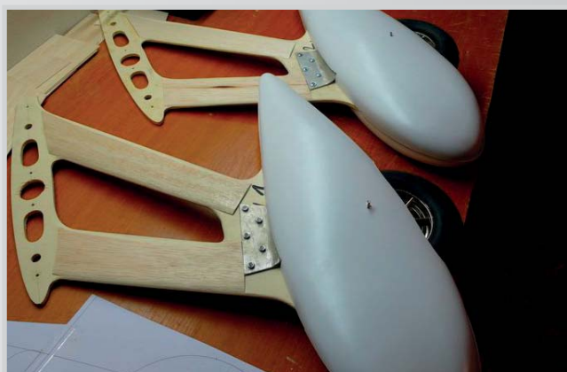
42. Sesazené bačkory - obě poloviny bačkor se slepí lepidlem vytvořeným rozlámaním zbytků materiálu bačkor do toluenu - uvnitř je potřeba vlepit 1,5-2 cm pásek z téhož materiálu pro zpevnění
