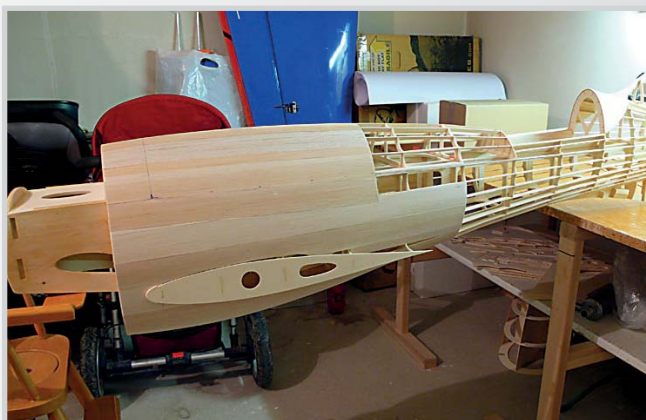
17. Kompletně potažená přední část trupu
