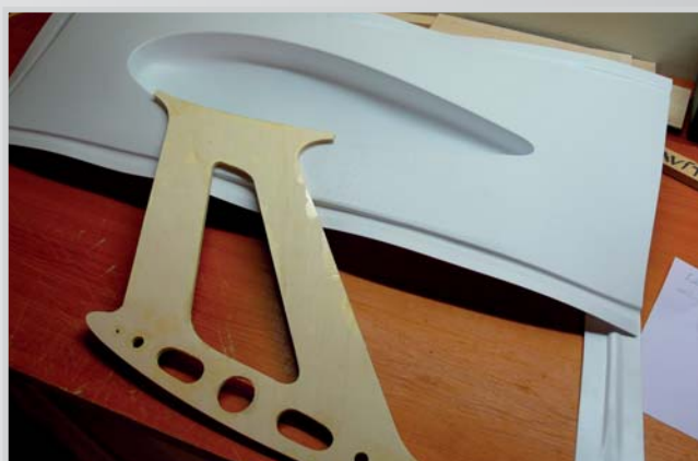
38. Příprava krytu kola k oříznutí
