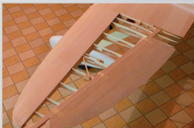
36. Potažená náběžná část a vrchní strana křídélka balzou
