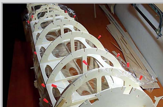
6. Spodní deska krytu kabiny s vlepenými přepážkami
