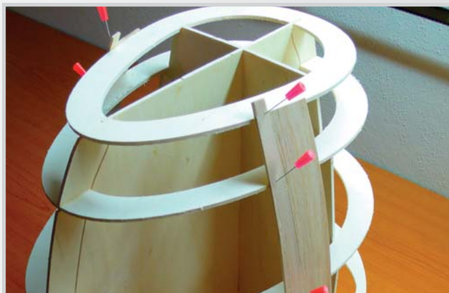
31. Kryt motoru je potřeba opáskovat - balza 2 mm
