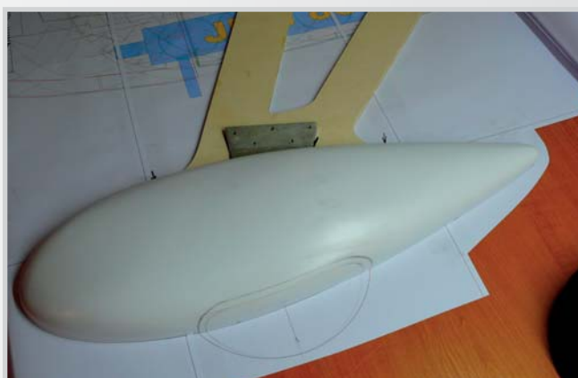
39. Příprava krytu kola k oříznutí
