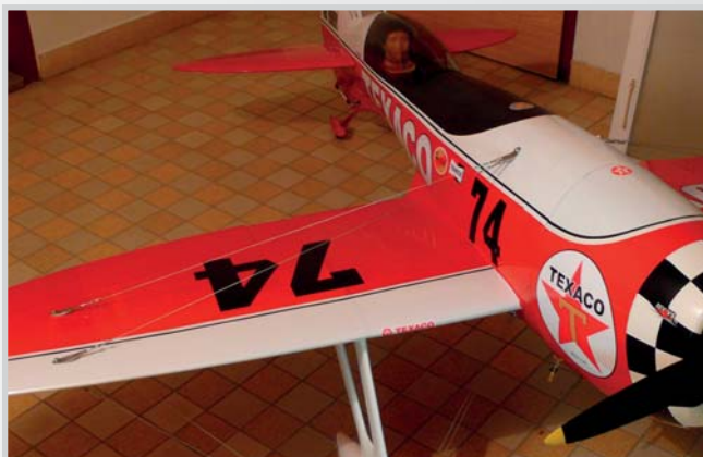
67. Dokončené lanoví kolem trupu a křídel
