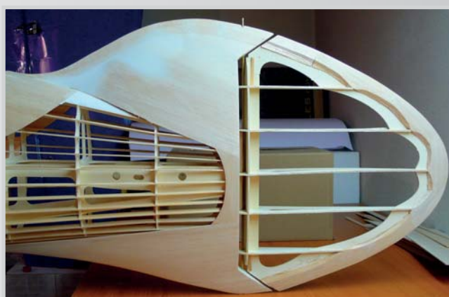
22. Hotová SOP - náběžný oblouk směrovky je potřeba ještě opáskovat balzou 2 mm
