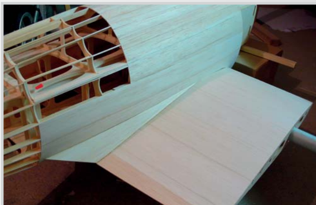
25. Napojení křídla k trupu se provede vlepením dalšího balzového dílu
