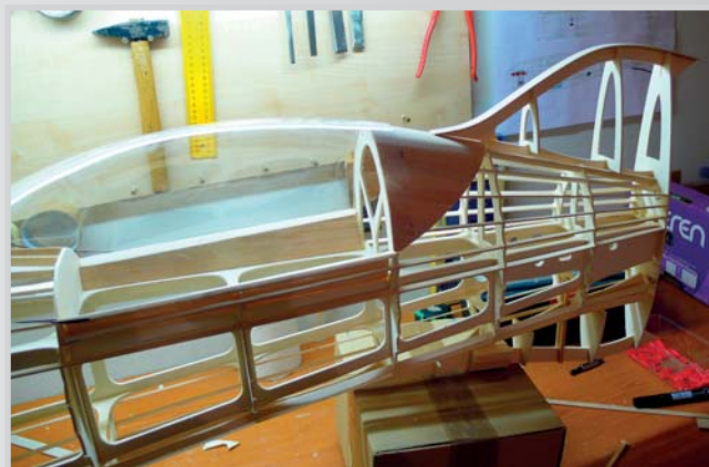
14. Balzová část za kabinou (balza 2 mm)
