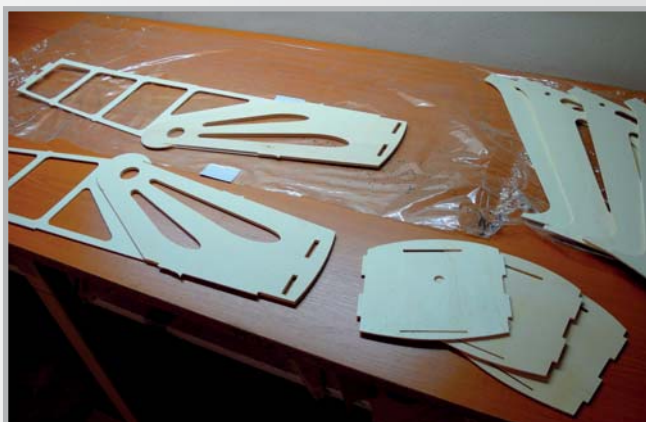
1. Lepení dvojité a trojitých částí motorového domku
