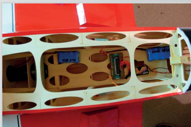
62. Příprava elektroinstalace - rozmístění akumulátorů a rozvodné desky
