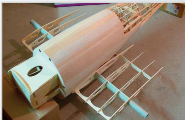
23. Žebra centroplánu se spojovací trubicou
