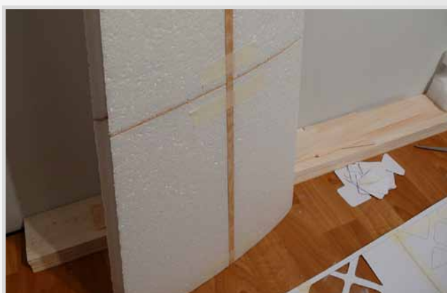
Vlepení podélných smrkových lišt
