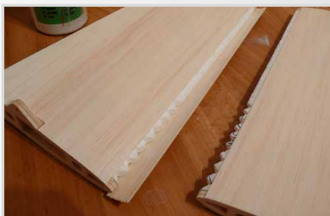
Polepení výškovky balzou 1mm
