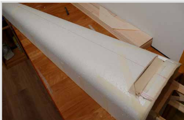
Příprava výřezu spodní části pro podvozek
