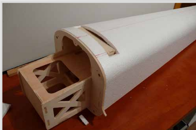
Příprava pro hlavní podvozek
