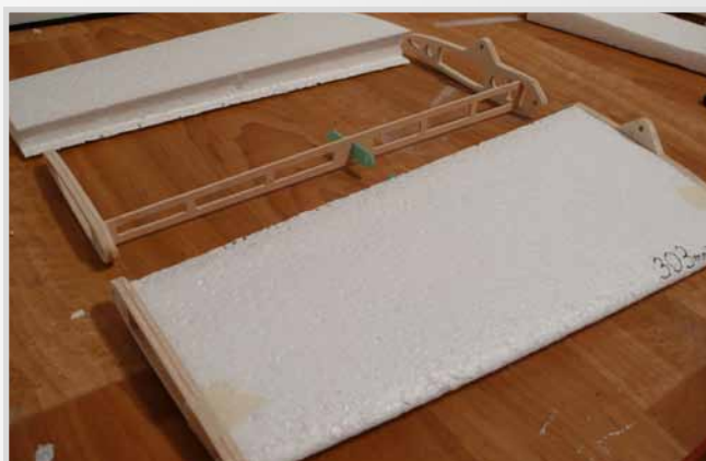
Příprava dílů výškovky a slepení s polystyrenovými jádry
