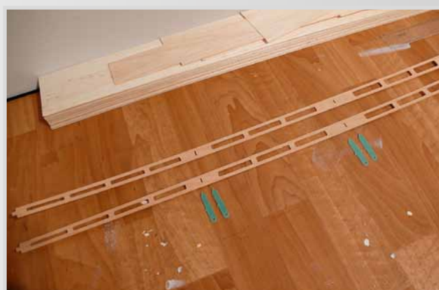
Příprava stojiny pro závěsy křídélka
