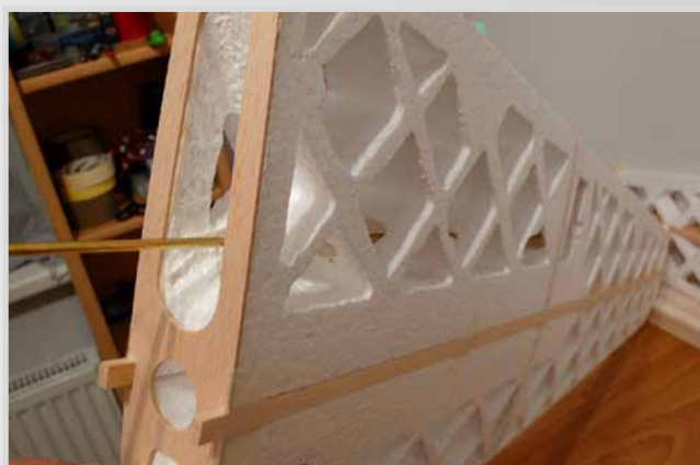
Proříznutí otvorů pro servokabel
