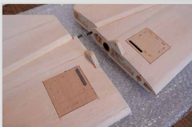
Kryt servokrabičky - přilepí se nakonec po potažení a instalaci serv
