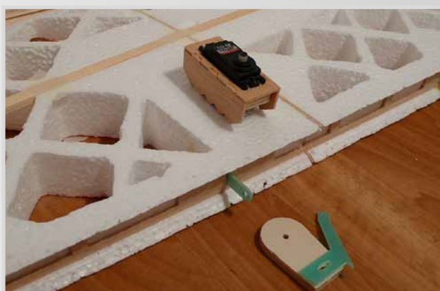
Příprava servodržáku v křídle
