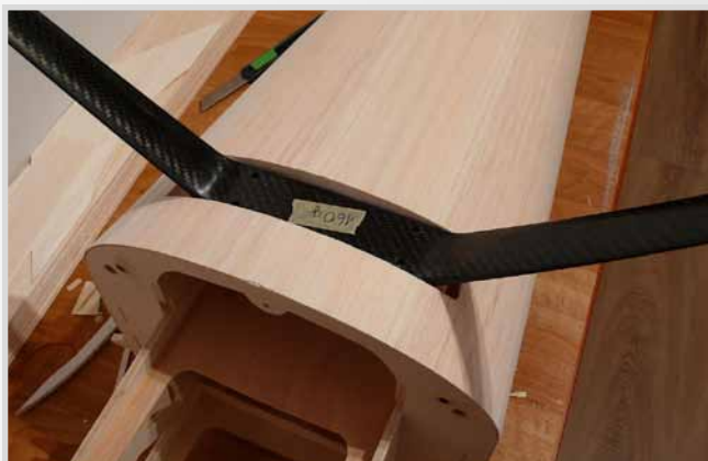
Sesazení trupu a podvozku
