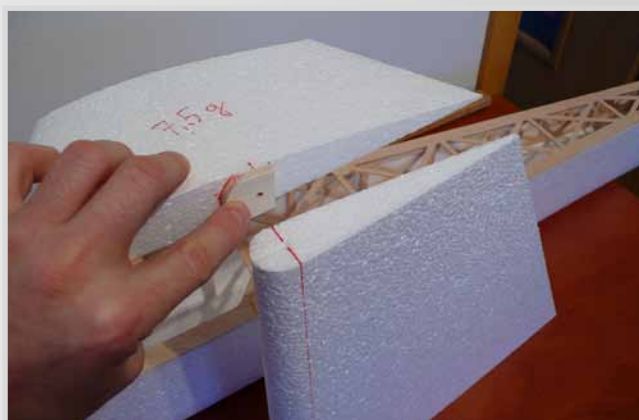
Vlepení položebner směrovky
