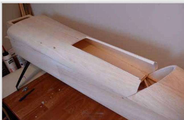
Odříznutí tvaru kabiny
