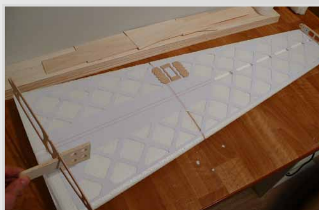
Příprava krajních žebér a přenesení tvarů vylehčovacích otvorů
