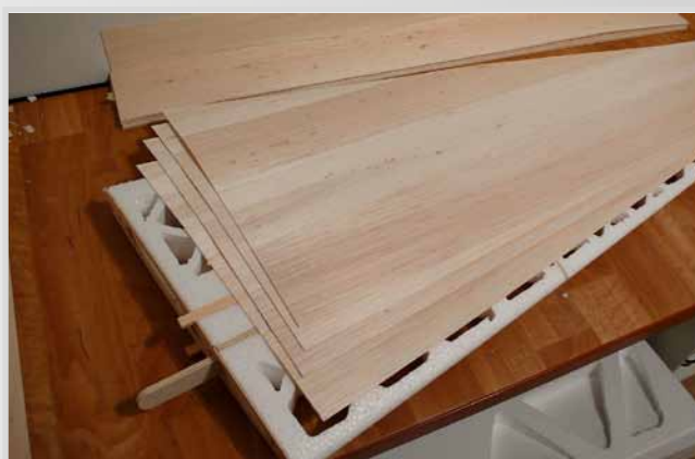
Příprava tuhého potahu - balsa 1mm
