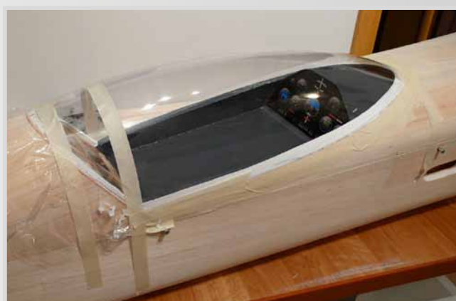
Hotový kokpit a přilepená kabina
