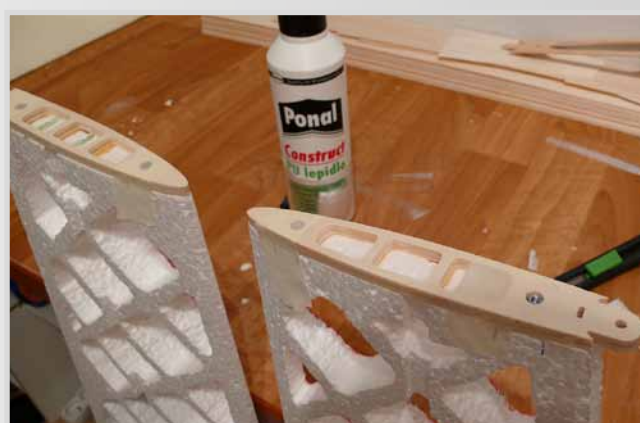
Přilepení krajních žeber - uvnitř zapichovací matky M4
