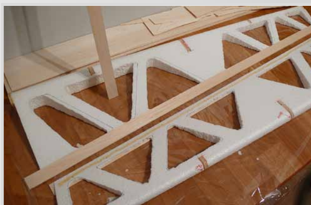
Potah křidélka: 1. varianta - odlehčený (na fotce) 2. varianta - křidélko potáhneme balsou celé (lepší)
