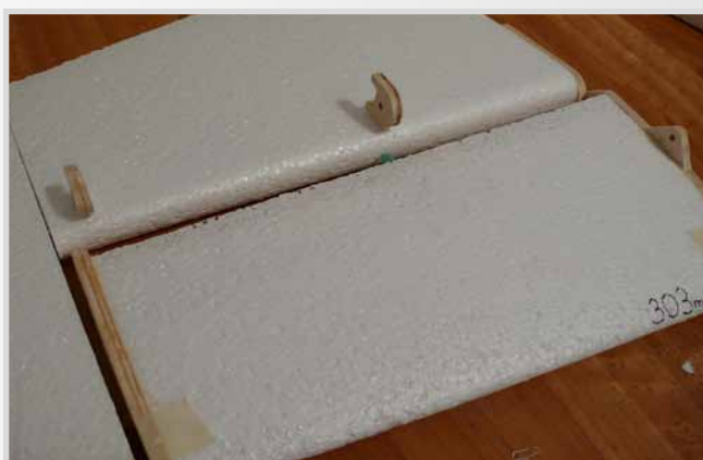
Příprava dílů výškovky a slepení s polystyrenovými jádry
