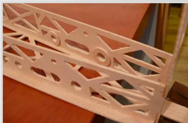
Zalepení výztuží pro kolíky z vnitřní strany bočnic
