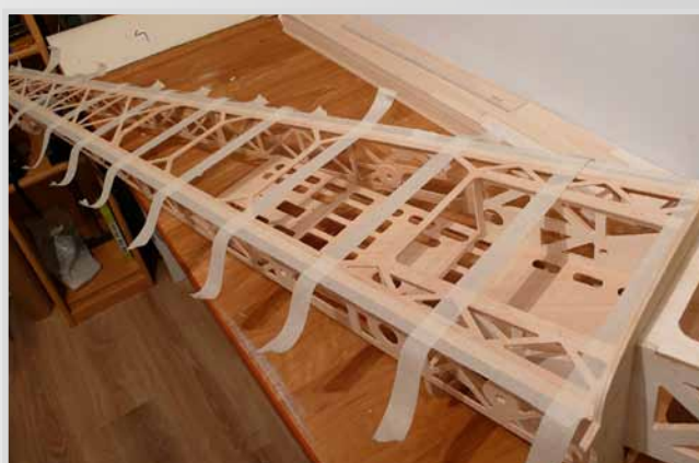
Příprava kostry trupu pro slepení s polystyrenem
