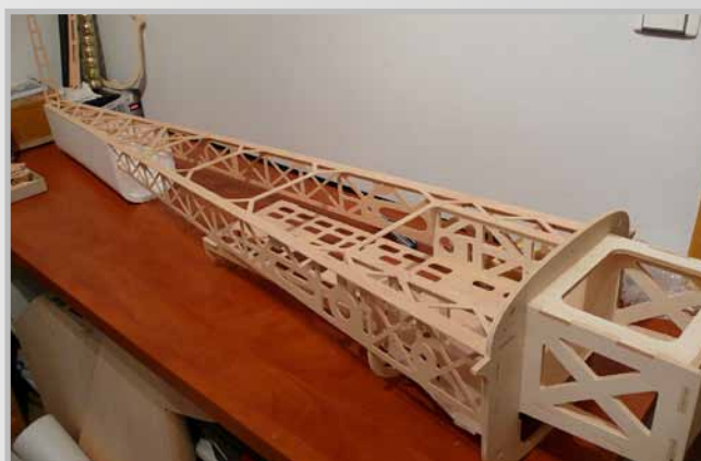
Zkouška nasazení na vnější polystyrenový tvar
