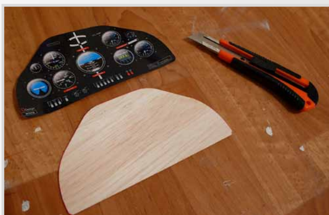
Příprava a vlepení přístrojové desky
