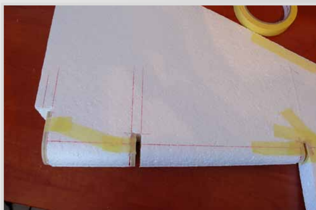
Vlepení položebler směrovky - spodní drží páku směrovky
