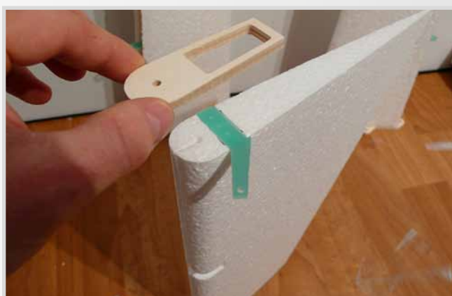
Příprava výřezu pro páku výškovky
