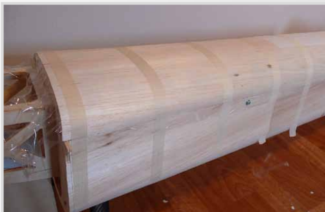
Slepení rámečku kabiny a polystyrenového hřbetu
