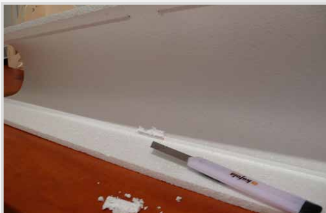
Výřez v místě spojení se spodní deskou v trupu
