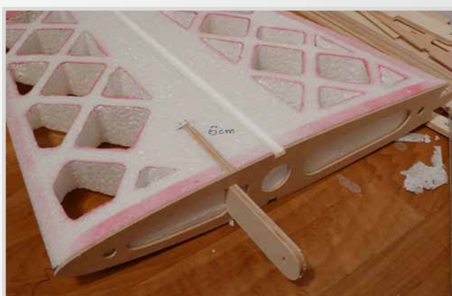
Vlepení spojky křídla a žebra
