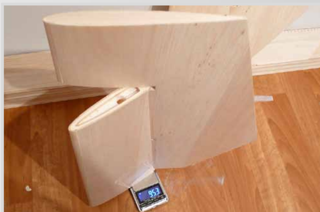
Kryt servokrabičky - přilepí se nakonec po potažení a instalaci serv
