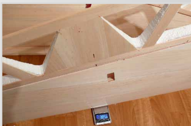
Potah křidélka: 1. varianta - odlehčený (na fotce) 2. varianta - křidélko potáhneme balsou celé (lepší)
