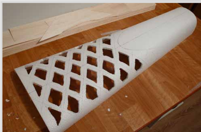
Vylehčení hřbetu kabiny (není nutné)
