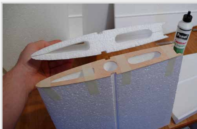
Vlepení překližkového žebra
