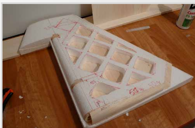
Potažení balsou 1mm
