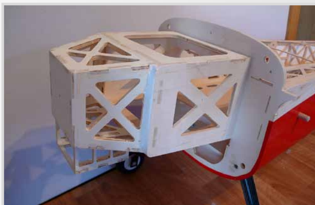
Varianta: prodloužený motorový domek v případě použití elektromotoru
