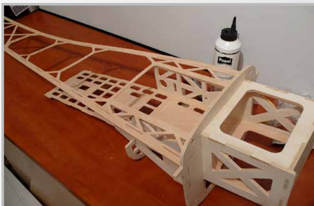
Slepení konstrukce trupu s motorovým domkem
