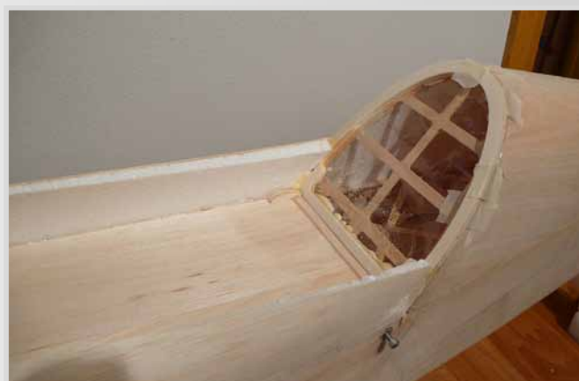
Vlepení přepážky za kabinou
