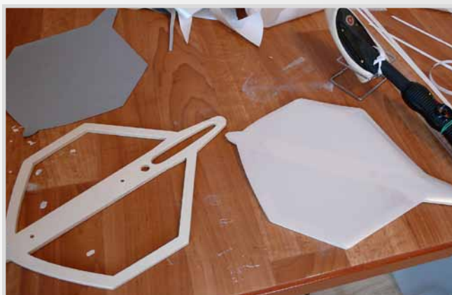
SFG - obroušené a potažené folií
