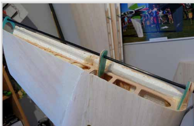
Vlepení sklolaminátových závěsů směrovky
