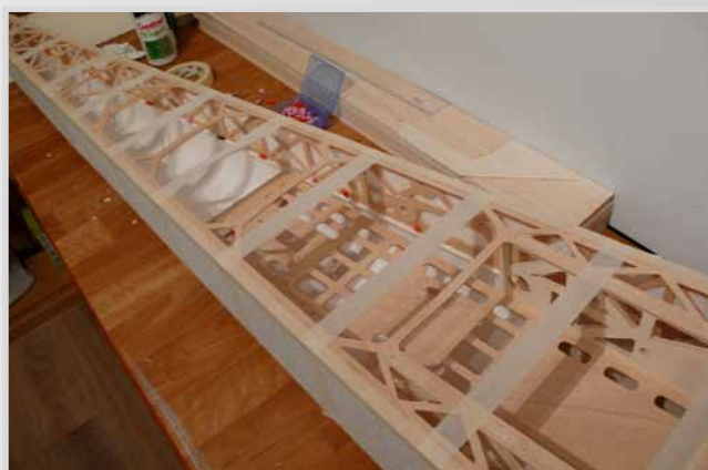
Kostra trupu vlepena do polystyrenových bočnic
